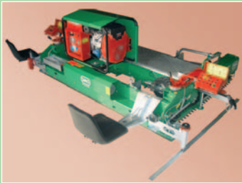
P928 Vollversion; mit Generator und Höhennivellierung
